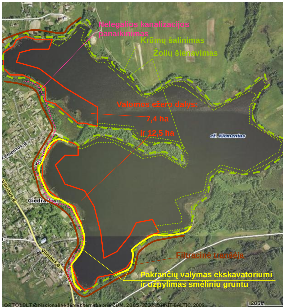
1.11.4 pav. Kiemento ežero tvarkymas ir uždumblėjusių dalių išvalymas
